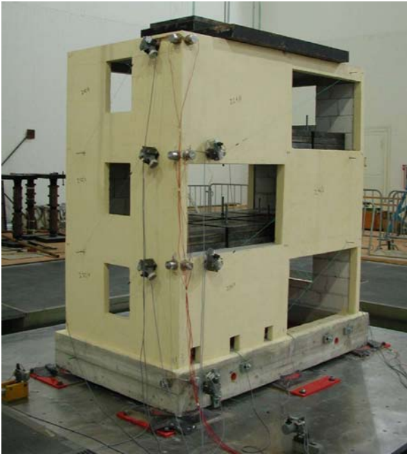
Fig. 2 Modello in scala \frac{1}{4} di un edificio convenzionale dotato di dispositivi di protezione sismica
